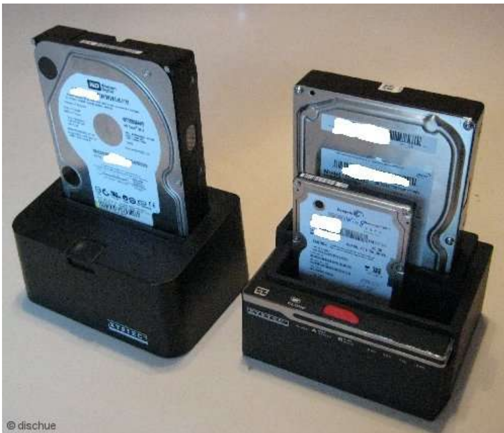
Abbildung 3: Festplatten-Dockingstationen: nehmen je Modell 1 oder mehrere interne Festplatten verschiedener Größe auf. Vorteile: Verschiedene Anschlüsse auch kombiniert möglich (USB 2.0, USB 3.0, eSATA) Festplatten lassen sich leicht tauschen, nur 1 Netzteil (der Dockingstation) für alle Festplatten (statt bei externen 3,5 Zoll Platten oft verschiedene Netzteile). Je nach Modell auch 1:1 Kopie von Festplatten ohne PC möglich (rechtes Modell). Nachteile: wie bei allen Festplatten: Vorsicht mit Erschütterungen bei laufender Platte.
