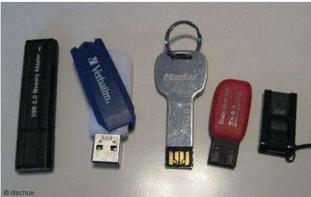
Abbildung 2: USB-Sticks, Vorteile: klein und handlich, keine bewegten Teile; Nachteile: Preis je Speichergröße höher als bei Festplatten, leicht zu verlieren, oft recht langsame Datenübertragung. Ausreichend, um z.B. die letzten Urlaubsbilder mit zu Freunden zu nehmen.
